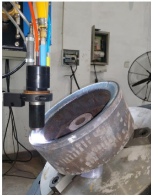
粉末等离子堆焊工艺已应用于工业制造业的多个领域，主要目的在于获得有特定性能（耐磨、耐蚀、耐温等性能）的合金硬面层。从应用角度有以下分类：按工件堆焊面的几何形状分类。主要分为：园平面、园锥面、园柱面、园柱螺旋面、平面线段或平面等。针对不同类型的工件，在工艺控制程序上有所区别。对于复杂的平面线段（连续或不连续的直线段或曲线段），要实现全自动堆焊，就要采用数控系统。对同一类型工件，在几何尺寸上相差甚大者，则要选择相适应的机型。按工件所属的制造行业分类。根据目前的应用情况，主要有：阀门制造行业、气门制造行业、冶金轧制工具制造行业、石油机械行业、煤矿机械行业、电力机械行业等等。随着应用范围的扩大，将会有更多的制造行业在产品的修造中采用粉末等离子堆焊技术。海南等离子堆焊设备多少钱粉末等离子弧堆焊适于易于制成粉末而难于制成丝材的高合金或复合材料堆焊。
